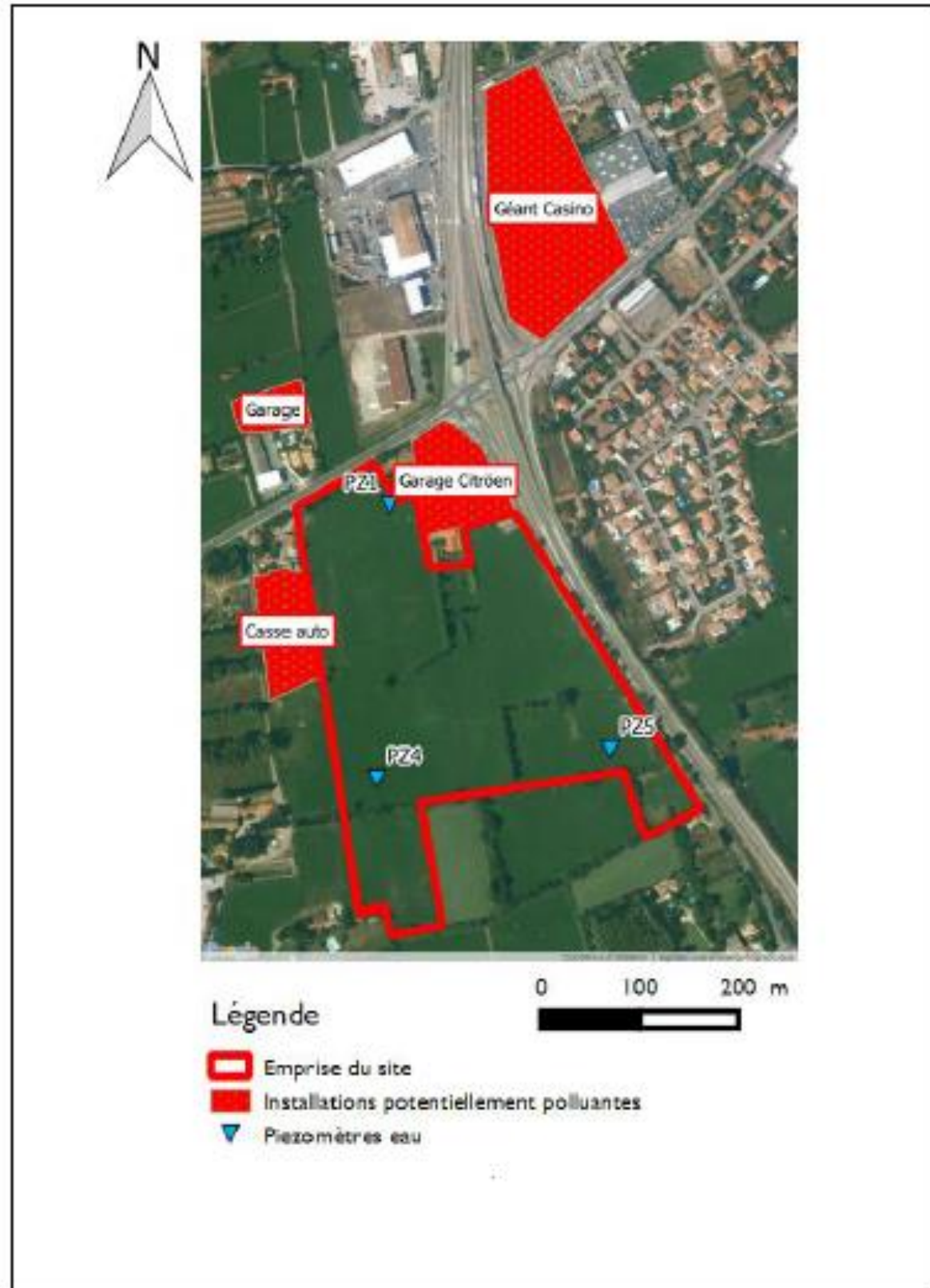
Localisation des piézomètres Source : Fondasol
